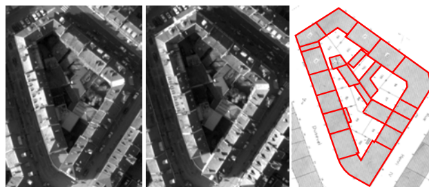
Figure 4 Données utilisés en entrée de l'approche développée par Jibrini : couple d'images et cadastre vectorisé.
