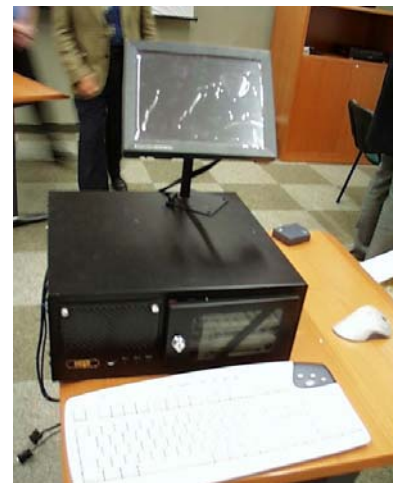
Vue du premier Enregistreur Numérique Universel (Source Carsense : 3 caméras, 2 radars, un télémètre laser et 2 bus CAN)
