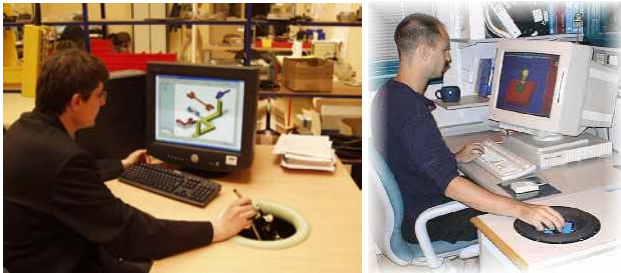
FIG. 5 - (Gauche) Virtuose 6D Mini-Desktop d'Haption - (Droite) Interface haptique CMU couplé à Newton.
