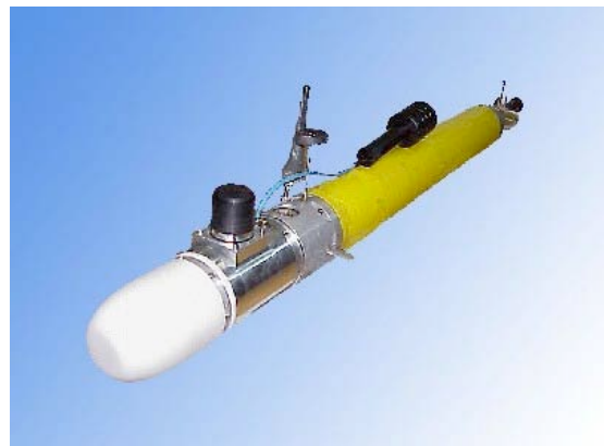
FIG. 2 – Modem acoustique, antennes GPS et radio, capteur de Température, salinité.
