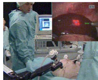
FIG. 6 – Contrôle des mouvements d'instruments en chirurgie laparoscopique par asservissement visuel sur l'image endoscopique
