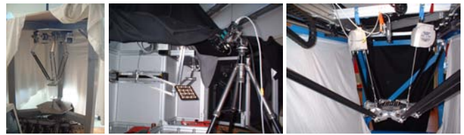
FIG. 3 – Machines sur lesquelles l'identification par vision a été expérimentée : H4 (LIRMM), Orthoglide (IRCCyN), I4L (LIRMM)
